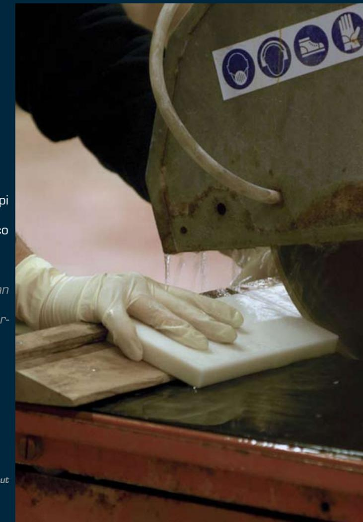
Alcuni operai scandiscono i passaggi per alcuni esempi di taglio effettuati su materiale STONEGLASS. In alto il taglio con punta di diamante, qui a fianco quello ad acqua.
