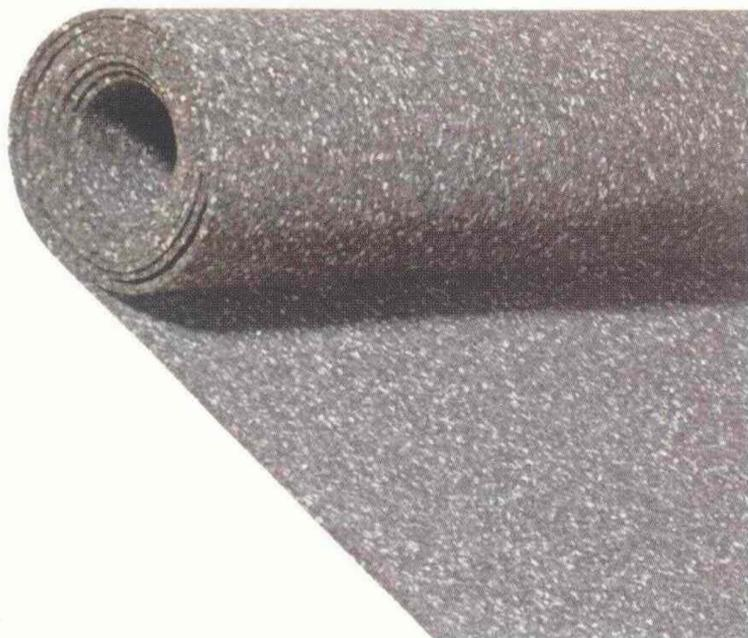
Regupol 3912 besteht aus PUR-gebundenem PUR-Schaum. Sein relativ geringes Gewicht und seine weiche Konsistenz machen es vor allem für textile Bodenbeläge geeignet. Selbstverständlich lässt sich Regupol 3912 auch unter alle anderen Oberbeläge verlegen. Regupol 3912 ist geeignet für Stuhlrollen und Fußbodenheizungen, ist dauerelastisch und alterungsbeständig.
