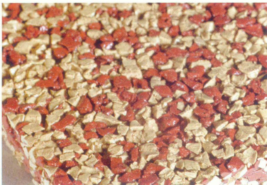
Fallschutzbelag aus fugenloser EPDM-Beschichtung, gewebefixiert auf Regupol-Softplatten.
