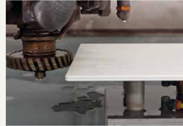
fig.27 /Per la formatura e lucidatura della costa, effettuare un primo passaggio con mola diamantata, per portare il bordo a misura e con la forma desiderata, seguito da un secondo passaggio con mola lucidante. /For the forming and polishing of the edge, the first step involves a diamond grinding wheel, to take the edge to the required size and shape, and the second step involves a polishing wheel
