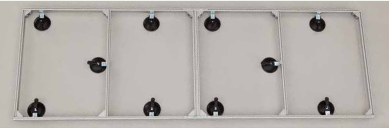
fig.9 / Per facilitare la movimentazione delle lastre 1000x3000 mm e FULL SIZE, soprattutto se indebolite da fori o aperture, è possibile utilizzare un apposito telaio munito di ventose (sistema EASY FRAME), disponibile a listino su richiesta. Verificare sempre la perfetta adesione delle ventose alla lastra prima della movimentazione soprattutto per ciò che riguarda decorazioni più strutturate, come ad esempio la serie Filo. /To ease moving the 1000x3000 mm and FULL SIZE slabs, especially when they are fragile due to holes or openings, and to ease use on vertical surfaces, a framework with suckers (EASY FRAME system) is available on request according to the pricelist. Always check that the suckers are properly attached before moving the slab.
