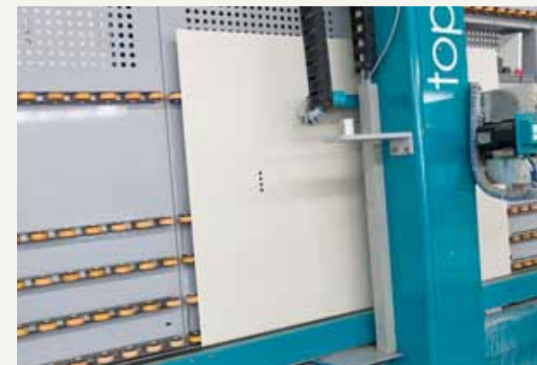
fig.23 / Operazioni di foratura possono esser condotte su qualunque formato di lastre Laminam, grazie alle apposite macchine ideate per forare vetro o pietre naturali. / Drilling operations can be performed on any Laminam slab format, thanks to the purpose-designed machines conceived to drill glass or natural stone.
