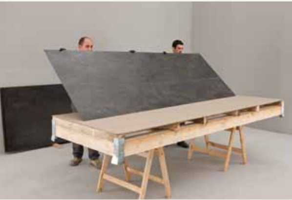
fig.8 / Sovrapporre più lastre in orizzontale, assicurandosi che le superfici siano pulite e che il piano di appoggio sia perfettamente planare. È possibile sovrapporre fino a un massimo di 50 lastre Laminam 3 assicurandosi che le lastre siano pulite e che il piano d'appoggio sia perfettamente planare. / Overlap several slabs horizontally, making sure the surfaces are clean and the supporting plane is perfectly flat. Up to max. 50 Laminam 3 slabs can be overlapped.
