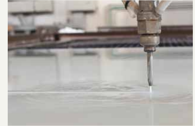
fig.24 / L'idrojet permette di realizzare fori con diametro anche inferiore a quello ottenibile con macchine a controllo numerico. Velocità di lavoro 1500 mm/min. / Water jets make it possible to drill holes with a smaller diameter than would be possible with a numerical control machine. Operating speed of 1,500 mm/min.
