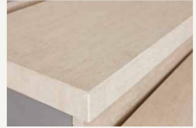
fig.29 /In genere, Laminam 3 e Laminam 3+ necessitano soltanto della bisellatura dello spigolo superiore, per Laminam 7 e Laminam 3+3 può esser prevista una doppia bisellatura: in questo caso si possono adottare gli utensili che realizzano l'operazione in un'unica passata di fresa. Per la bisellatura dei tagli curvilinei occorre necessariamente adoperare una macchina a controllo numerico con mola a 5 assi. Per effettuare molatura a mano, attaccare un disco abrasivo ad una smerigliatrice ed eseguire la bisellatura. In questo caso la precisione del risultato dipenderà dall'abilità dell'operatore che esegue il lavoro.. / Generally, Laminam 3 and Laminam 3+ only require the chamfering of the upper edge, while dual chamfering can be envisaged for Laminam 7 and Laminam 3+3; in this case, tools which achieve this dual operation in a single milling process can be used. To chamfer curved cuts, a numerical control machine with a 5-axis grinding wheel must be used. To perform manual grinding, attach an abrasive disk to a grinding machine and perform the chamfering. In this case, the accuracy of the result will depend on the skill of the operator performing the task.
