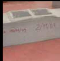
Immagine del provino con le piastrelle incollate (senza supporto in polipropilene)
