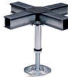
Traversina tubolare di sezione 38x33 mm, spessore 1,2 mm, con elemento longitudinale lungo 180 cm e trasversale lungo 55 cm. Struttura consigliata per carichi di esercizio molto gravosi o altezze notevoli (archivi, magazzini, sale controllo, ecc...).
