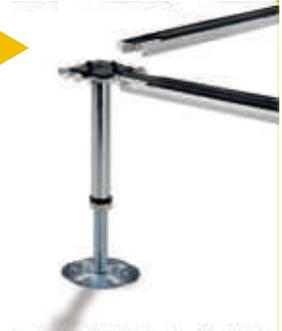
Traversina rinforzata con sezione ad "U" aperta di 40x30x40 mm, spessore 0,9 mm, con funzione portante. La traversina viene inserita a scatto sulla testa del piedino.
