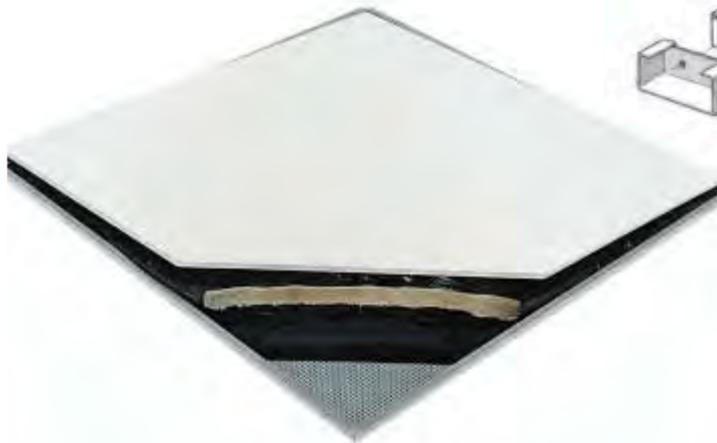
Pannello metallico forato reso fonoassorbente da un tessuto non-tessuto applicato a caldo sul retro e da un ulteriore materassino assorbente; il pannello inoltre viene reso fonoisolante da una lastra in cartongesso inserita sul retro.
