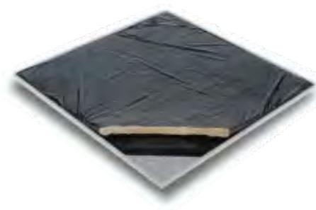
pannello metallico forato reso fonoassorbente da un tessuto non-tessuto applicato a caldo sul retro e da un ulteriore materassino di lana minerale imbustata in contenitore di polietilene autoestinguente sigillato a caldo
