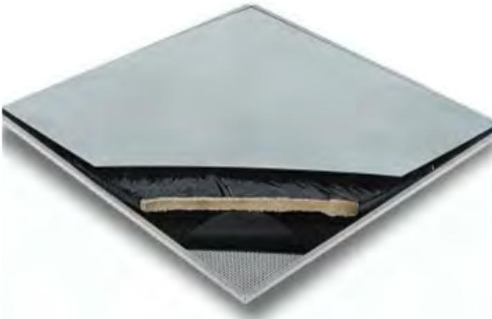
Pannello metallico forato reso fonoassorbente da un tessuto non-tessuto applicato a caldo sul retro e da un ulteriore materassino assorbente; il pannello inoltre viene reso fonoisolante da un pannello scatola in lamiera di acciaio inserito sul retro.
