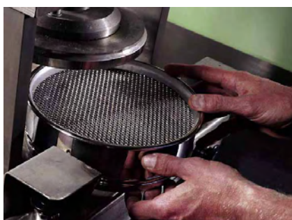
Teste sieve production
