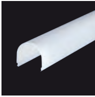
Acrylabdeckung satiniert Acrylic cover satinised Diffuseur en acrylique satiné L x H mm kg 6556 1000 x 50 0,4 6557 2000 x 50 0,6 6533 3000 x 50 0,8
